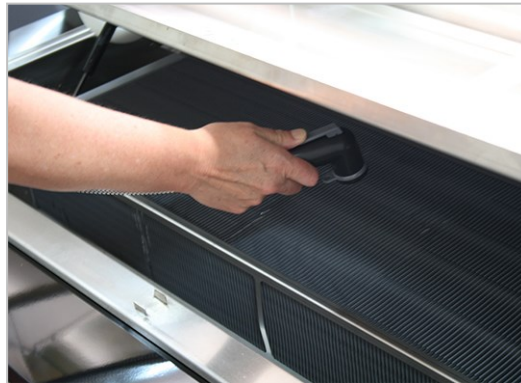
Abb. 6.11 Verdampfer mit Brause oder weicher Bürste reinigen.
