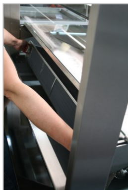
Abb. 6.10 Verdampfer aushaken und auf dem Wannenboden ablegen.
