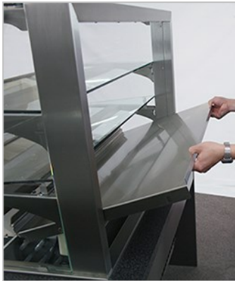
Abb. 6.12 Warenauslage zur Bedienseite herausziehen und auf dem Wannenrand ablegen.
